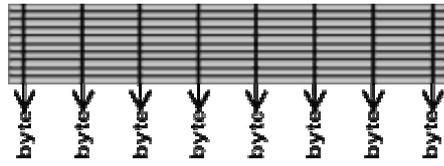
Parallele al nastro, scorrono 9 tracce. Sulle prime otto vengono memorizzati i byte, perpendicolarmente al nastro. Sull' ultima, per ogni byte memorizzato, si trova un bit di *parità trasversale*. Dopo un certo numero di byte, per comodità in quantità pari ad un record, si trova un byte di *parità longitudinale*. In questo modo è possibile identificare, come in una matrice, i bit errati e correggerli (basta complementarli).
