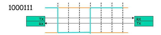
Problemi di sincronizzazione del ricevitore (nessuna transizione nel caso di sequenze di zeri o di uni)→ NRZ 5B6B o 4B5B
