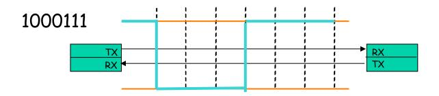
Problemi di sincronizzazione del ricevitore (nessuna transizione nel caso di sequenze di zeri o di uni)→ NRZ 5B6B o 4B5B
