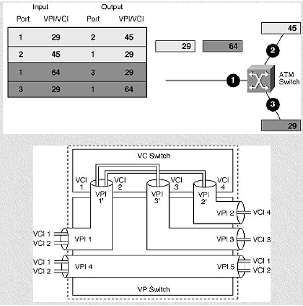
La coppia VPI/VCI ha solo significato *locale* nel senso che vale esclusivamente all'interno di un link, ogni volta che la connessione attraversa uno switch la coppia VPI/VCI in genere viene cambiata ed in questo consiste il meccanismo di switching ovvero nel determinare in base ad una tabella di instradamenti come si mappano le connessioni in base alle porte di provenienza ed al VPI/VCI delle celle
