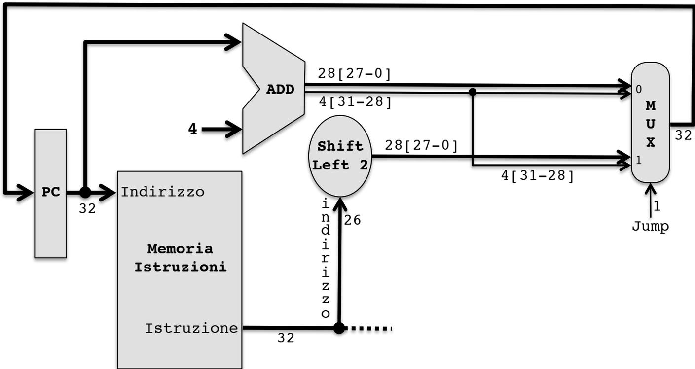
Porzione del datapath che esegue sia le istruzioni di branch (beq) che l'istruzione di jump (j)
