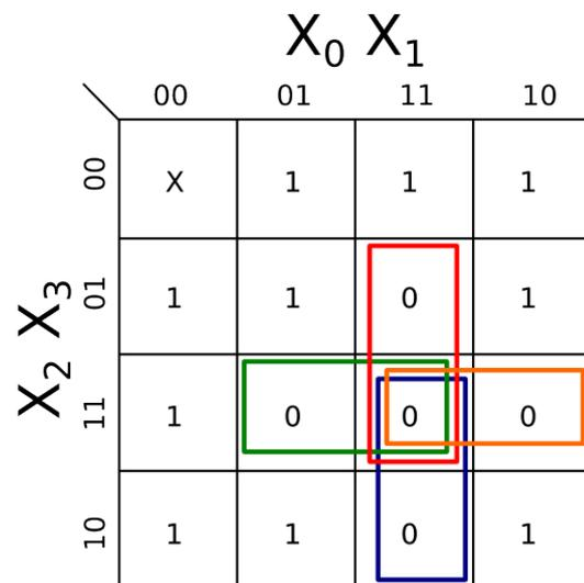
$$Y_1 = (\overline{X_0} + \overline{X_1} + \overline{X_2}) (\overline{X_1} + \overline{X_2} + \overline{X_3}) (\overline{X_0} + \overline{X_2} + \overline{X_3}) (\overline{X_0} + \overline{X_1} + \overline{X_3})$$
