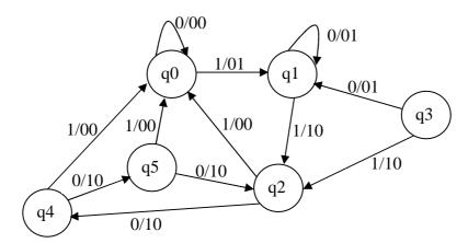
Progettare la rete sequenziale che realizza l'automa minimo. In particolare: stendere la tavola degli stati futuri considerando un flip flop di tipo D per il bit più significativo e un flip flop di tipo JK per il secondo (2 punti); ricavare le espressioni minimali per le funzioni di eccitazione e le uscite (2 punti); disegnare il circuito (1 punto).
