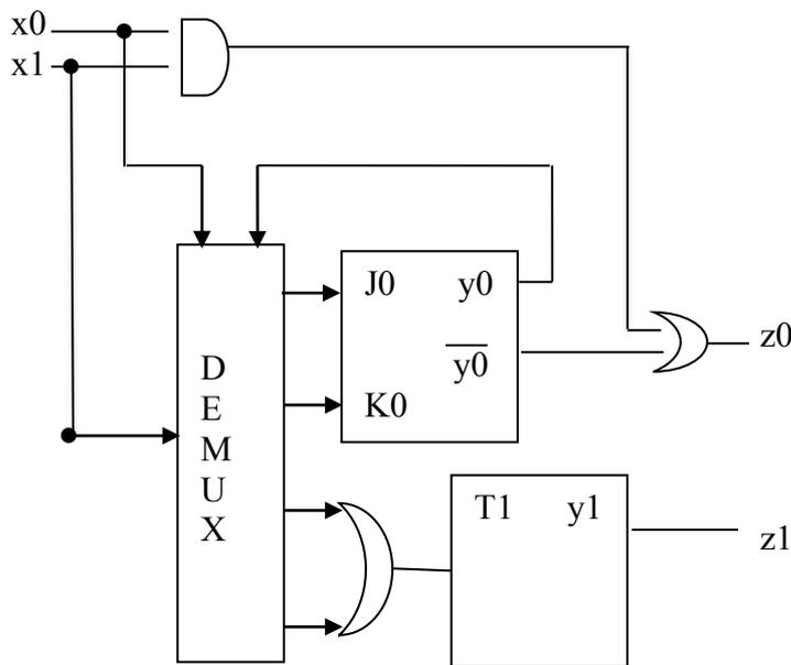
Disegnare poi il diagramma temporale a partire dallo stato  $y_1 y_0 = 10$  per la sequenza di ingresso  $x_1 = 100001$  e  $x_0 = 001111$ .
