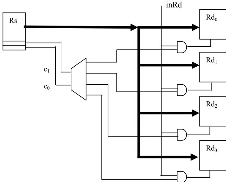
Dovendo dettagliare fino a livello di porte logiche, esplicitiamo il decodificatore. La tabella di verità del decodificatore si presenta nel seguente modo, dove  $r_0$ ,  $r_1$ ,  $r_2$  ed  $r_3$  sono le uscite del decodificatore, usate poi per costruire (in AND con il segnale inRd) il segnale di abilitazione dei registri  $Rd_0$ ,  $Rd_1$ ,  $Rd_2$  ed  $Rd_3$ , rispettivamente:
