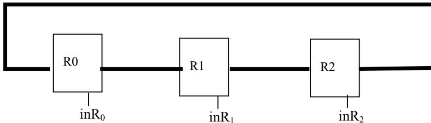
Bisogna poi progettare la parte circuitale che permette di ottenere i valori dei segnali di controllo  $inR_0$ ,  $inR_1$  e  $inR_2$ . Le condizioni poste per ottenere il trasferimento da  $R_1$  a  $R_2$  (linea di controllo  $inR_2$ ) e da  $R_2$  a  $R_0$  (linea di controllo  $inR_0$ ) suggeriscono di utilizzare le uscite di due comparatori, come mostrato nel disegno sotto:
