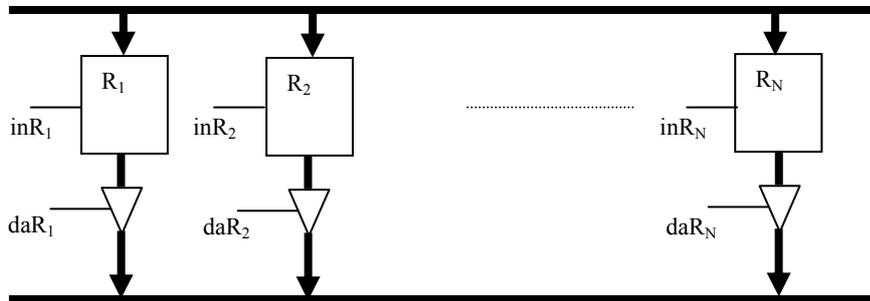
L'interconnessione viene realizzata utilizzando un singolo fascio di  $k$  linee (dove  $k$  è il numero di FF componenti i registri) che prende il nome di *bus*. Le entrate dei registri sono collegate direttamente al bus, mentre le uscite sono collegate al bus tramite un buffer tri-state. Per effettuare il trasferimento da  $R_i$  ad  $R_j$  è sufficiente attivare la linea di controllo  $daR_i$  dell' $i$ -esimo buffer tri-state e la linea di selezione  $inR_j$  del  $j$ -esimo registro.
