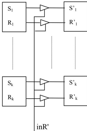
E' possibile realizzare una rete che permetta il trasferimento in modo bidirezionale tra R e R', naturalmente dotando anche R di una linea di selezione.
