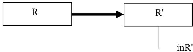
Ogni volta che si deve eseguire un trasferimento da R a R', la linea di selezione inR' va posta ad 1. Nello schema seguente si vede che il segnale di controllo inR' agisce su porte logiche ed abilita il trasferimento.
