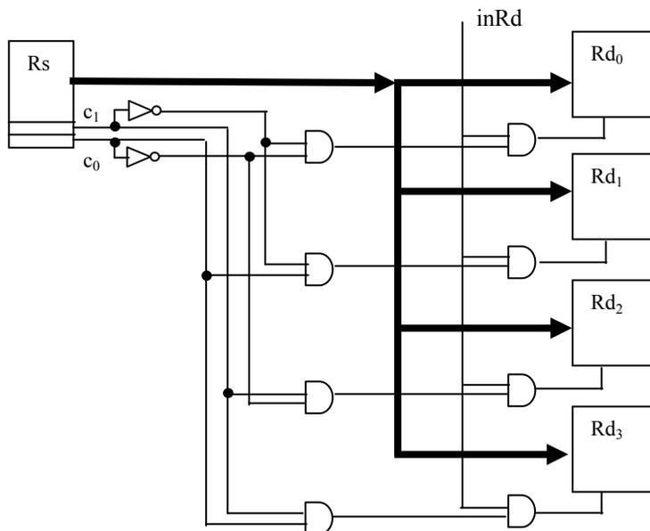
**Esempio 2.** Si progetti un sistema di trasferimento fra i registri  $R_0$ ,  $R_1$  ed  $R_2$  tale che:
