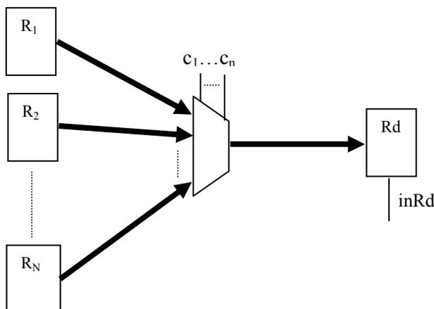
I segnali di selezione del multiplexer sono  $c_1, \dots, c_n$  (dove n è la parte intera superiore di  $\log N$ ) e forniscono la codifica binaria dell'indice i del registro  $R_i$  il cui contenuto deve essere copiato in  $R_d$ . Il multiplexer nella figura sopra, con ingressi ed uscita in grassetto, indica un insieme di k multiplexer ognuno utilizzato per uno dei K flip-flop (cella di memoria elementare) componenti i registri:
