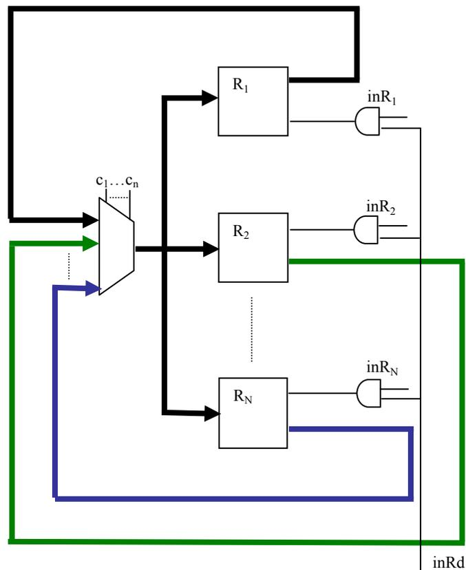
Il contenuto del registro sorgente  $R_i$  viene trasferito all'uscita del multiplexer se le linee di controllo  $c_1 \dots c_n$  codificano l'indice  $i$ . Il contenuto del registro sorgente viene trasferito nel registro destinazione  $R_j$  se le linee di controllo  $inR_j$  e  $inR_d$  sono entrambe 1. L'impostazione a 1 della linea  $inR_j$  si può ottenere tramite un decodificatore, impostando al valore  $j$  le sue linee di controllo.
