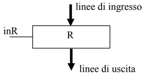
La freccia in grassetto indica un insieme di  $k$  linee, una per ogni cella elementare (flip-flop) componente il registro; quindi nel disegno a fianco è rappresentato un registro ad ingresso ed uscita paralleli. La linea di selezione *inR* serve per selezionare tutte le  $k$  celle elementari da un bit che compongono il registro.
