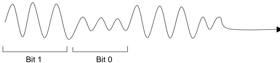
Questo è il tipo di modulazione più vulnerabile al rumore. L'ampiezza delle onde viene facilmente "camuffata" dal disturbo sul segnale
