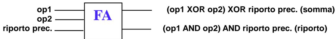
**Adder:** N Full Adder collegati in serie. Il riporto prodotto da ognuno dei full-adder va nel full-adder successivo. Occorre attendere un tempo di propagazione del riporto, proporzionale a N, per ottenere il risultato della somma
