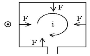
e sia  $\vec{B}$  un campo magnetico esterno, perpendicolare al foglio e uscente. Sui vari tratti del filo agiranno le forze indicate in figura che tendono a deformare la spira, ciascuna avente modulo
