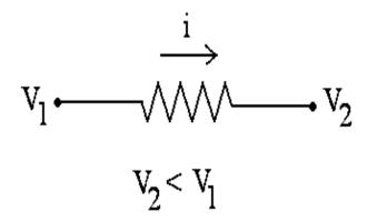
$$dL = dq \ (V_1 - V_2) = i \ dt \ (V_1 - V_2)$$
