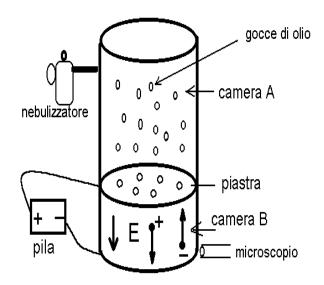
Delle goccioline di olio vengono immesse tramite un nebulizzatore nella camera A. Alcune di esse saranno cariche positivamente, altre negativamente. Nella camera B si genera un campo elettrico rivolto verso il basso. Attraverso la piastra forata P, alcune gocce passano nella camera B, dove saranno soggette alla forza elettrica  $\vec{F} = q\vec{E}$ , diretta verso l'alto per quelle negative e verso il basso per quelle positive. Consideriamo per es. una goccolina di massa m e carica q positiva
