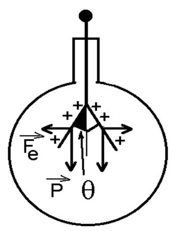
Se si deposita sull'asta una carica Q, questa si distribuisce sul conduttore e le due lamine si respingono, perche' cariche dello stesso segno. Raggiunto l'equilibrio, la risultante dei momenti delle forze agenti sulle lamine rispetto al punto  $\mathbf O$  deve essere zero:
