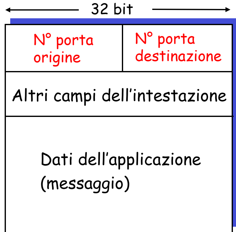
Struttura del pacchetto TCP/UDP
