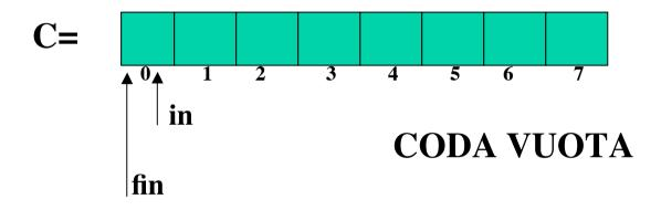
Gli elementi della coda sono quelli nel vettore C compresi tra C[in] e C[fin-1] inclusi. L'inserimento avviene in C[fin] e poi fin è incrementato di uno.
