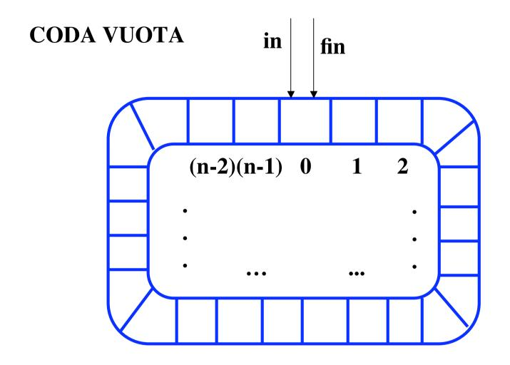
L'incremento di fin dopo l'inserimento deve avvenire modulo n, la dimensione del vettore.
