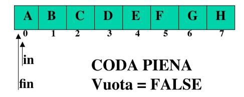
ad ogni estrazione, che può avvenire solo se Vuota è FALSE, si controlla se l'incremento di in porterà allo stesso valore di fin e in tal caso Vuota diventa di nuovo TRUE.
