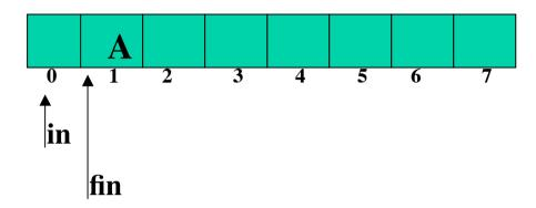
Sacrificando una entrata del vettore si evita di dover introdurre una nuova variabile.
