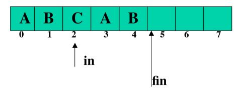
L'estrazione avviene salvando C[in] e incrementando in, sempre modulo la dimensione della coda
