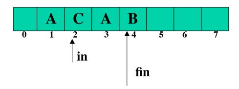
L'estrazione, come nella versione 1, avviene salvando l'elemento C[in] e poi incrementando in, modulo la dimensione del vettore
