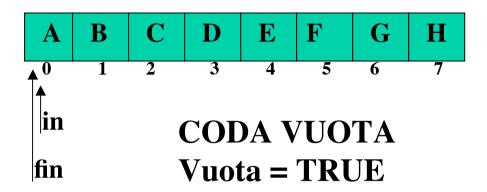
Per distinguere i due casi introduciamo una variabile booleana, Vuota, inizialmente posta a TRUE e che ad ogni inserimento diventa FALSE
