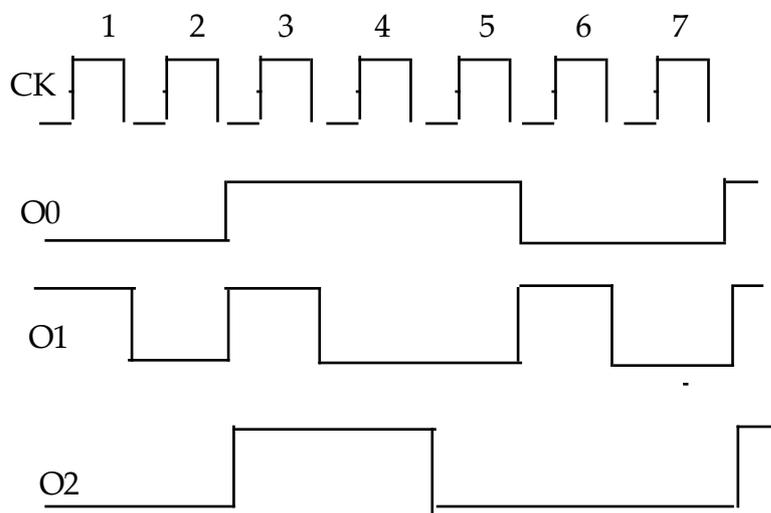
Utilizzare FF di tipo D (come ovvio dalla figura, sensibili al fronte di discesa del clock). Progettare il circuito con un PLA.
