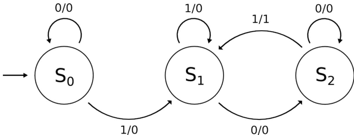
Dobbiamo rappresentare 3 stati e ci serviranno quindi 2 flip/flop, che chiameremo 0 e 1. Rappresentiamo ogni stato dell'automa con una coppia di valori  $Q_1, Q_0$ :  $S_0$  con (0,0),  $S_1$  con (0,1) e  $S_2$  con (1,0).
