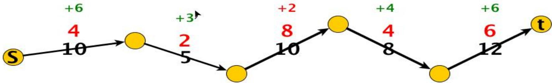
Nell'esempio in figura un cammino  $P$  in cui possiamo incrementare il flusso. Il suo bottleneck è 2.
